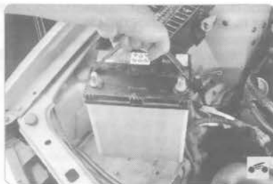
13. ...и извлеките аккумуляторную батарею из моторного отсека автомобиля.
