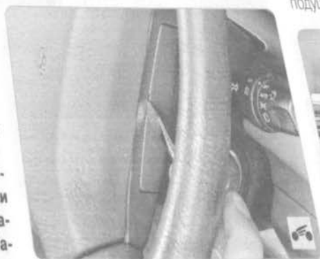
4. Поверните рулевое колесо на 90° против часовой стрелки и, поддев отверткой...
