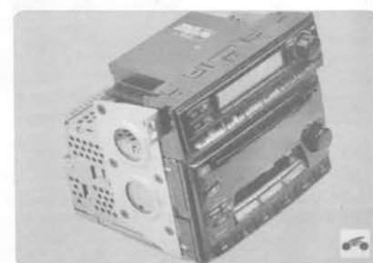
12. Снимите автомагнитолу и блок управления системой вентиляции, отопления и кондиционирования.
