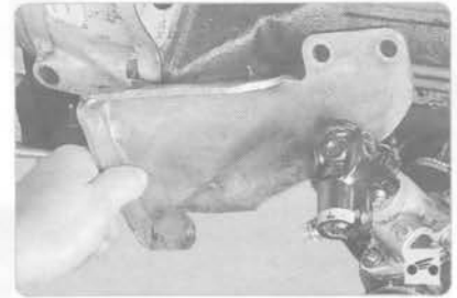
79. ...и снимите экран.
