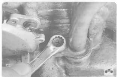
32. Выверните болт крепления направляющей трубки указателя (щупа) уровня рабочей жидкости в коробке передач...
