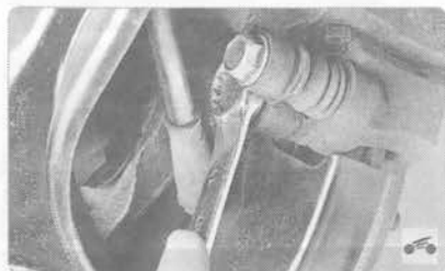
9. При необходимости выпрессуйте сайлентблок с помощью подходящих оправок. Признаками износа сайлентблока являются разрывы, одностороннее выпучивание и отслоение резины от металлической втулки.
