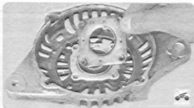
10. ...и снимите прижимную гластину подшипника.
