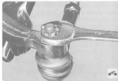
15. ...и отверните гайку.
