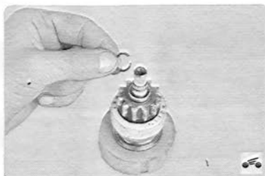
21. ...и снимите стопорное кольцо...
