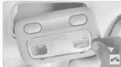
6. Разъедините колодку с проводом под задней полкой...
