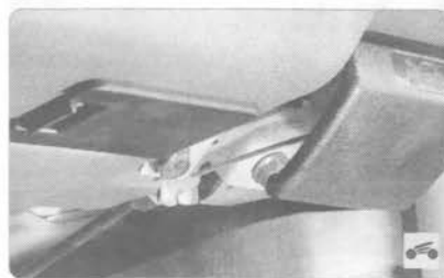
1. Потяните за рычаг троса замка капота...
