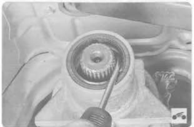
32. Выверните болт крепления направляющей трубки указателя (щупа) уровня рабочей жидкости в коробке передач...
