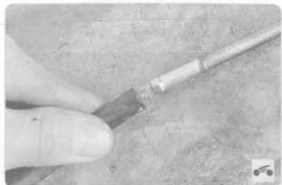
31. Отсоедините шланг от сапуна автоматической коробки передач.
