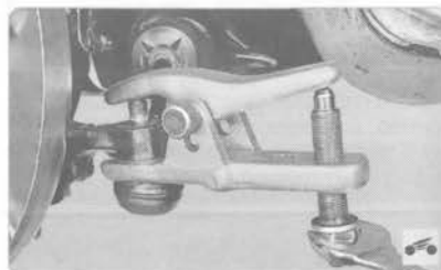
16. Установите съемник шаровых шарниров...
