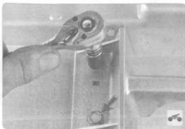
4. Выверните два болта крепления декоративной накладки к переднему бамперу...
