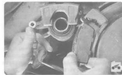
5. ...и извлеките наружную и внутреннюю тормозные колодки.
