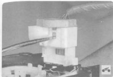
19. ...отверткой отожмите фиксатор колодки...
