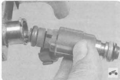
5. Извлеките хвостовик форсунки из отверстия рампы.
