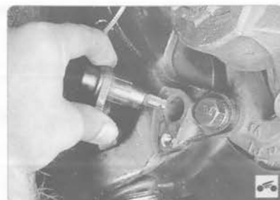
4. ... извлеките датчик из гнезда кулака и закрепите на кронштейне стойки.
