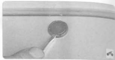
6. Извлеките фиксаторы трех пистонов верхнего крепления заднего бампера...
