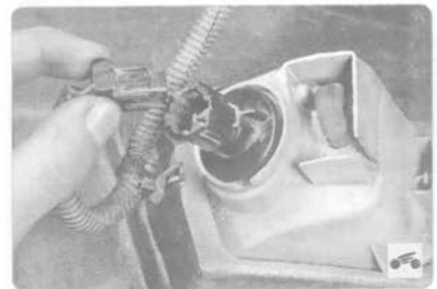
3. ...и отсоедините колодку от лампы фары.
