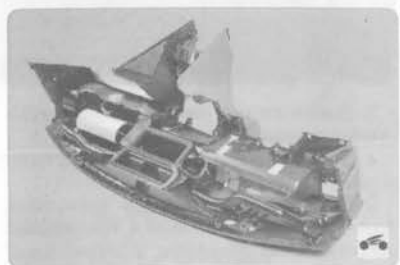
Рис. 11.10. Панель приборов: 1 – зона установки подушки безопасности; 2 – блок управления системой отопления, вентиляции и кондиционирования; 3 – информационный дисплей; 4 – облицовка комбинации приборов; 5 – накладка комбинации приборов; 6 – верхняя декоративная вставка центральной части консоли; 7 – комбинация приборов; 8 – нижняя облицовка панели приборов; 9 – декоративная панель селектора автоматической коробки передач; 10 – аудиосистема; 11 – накладка центральной консоли панели приборов; 12 – вещевой ящик
