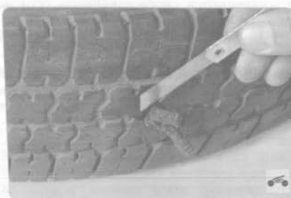
12. Обрежьте оставшиеся на поверхности концы жгута в уровень протектора.
