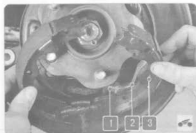
Рис. 9.7. Разжимной рычаг тормозного механизма: 1 – трос стояночного тормоза; 2 – разжимной рычаг; 3 – задняя колодка стояночного тормозного механизма
