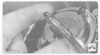
4. Поверните крышку лампы противотуманной фары против часовой стрелки...
