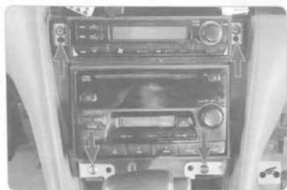
Так расположены винты крепления автомагнитолы и блока управления отопителем и кондиционером к каркасу консоли.
