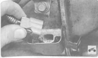
37. Отсоедините колодку от датчика частоты вращения коленчатого вала.
