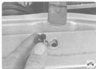
17. ...снимите пистоны верхнего крепления переднего бампера...
