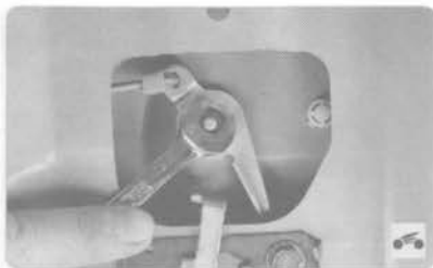
6. Отверните гайку крепления рычага замка, снимите гайку...
