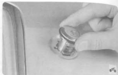
11. Извлеките личинку замка из отверстия в крышке багажника.
