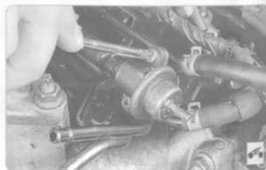
37. Выверните винты крепления регулятора давления топлива.
