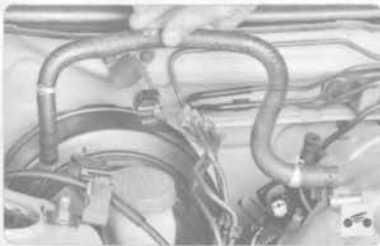
8. Снимите вакуумный шланг.
