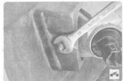
4. Отверните гайку крепления фары...
