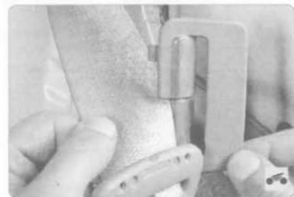
8. Через прорезь извлеките ремень из декоративной накладки.
