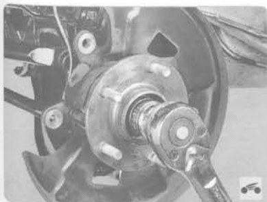
11. Отверните гайку ступицы...
