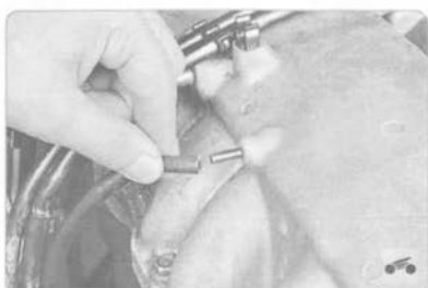
26. Снимите шланги вакуумных магистралей с наружной...
