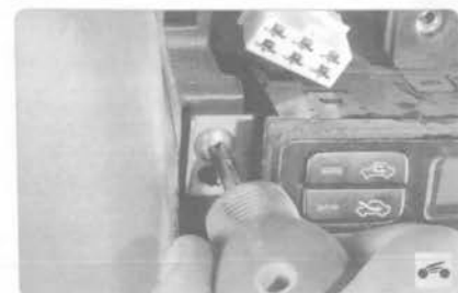
4. Выверните четыре винта крепления...
