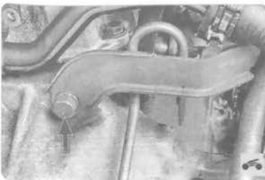
70. Снимите шланг вакуумного усилителя тормозов с патрубка впускного коллектора (см. «Проверка работы вакуумного усилителя тормозов», с. 69).
