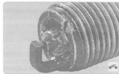
7. Детонация. Изолятор свечи растрескавшийся или со сколами. Это может привести к повреждению поршня. Убедитесь, что октановое число бензина соответствует требуемому.
