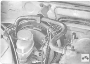
70. Снимите шланг вакуумного усилителя тормозов с патрубка впускного коллектора (см. «Проверка работы вакуумного усилителя тормозов», с. 69).
