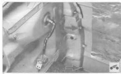
8. ...и снимите задний бампер с автомобиля. 9. Установите бампер в порядке, обратном снятию.
