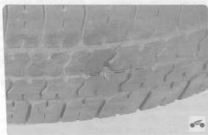
13. Подождите указанное в прилагаемой к ремонтному набору инструкции время, необходимое для полимеризации клея, и доведите давление в шине до рекомендуемого.
