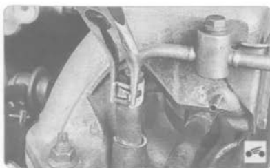
28. Сожмите пассатижами отогнутые ушки хомута шланга подогрева дроссельного узла, сдвиньте хомут по шлангу...
