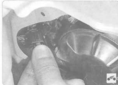
17. Для замены лампы переднего указателя поворота нажмите на фиксатор...
