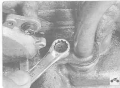
73. Выверните болт крепления трубки указателя уровня жидкости автоматической коробки передач...
