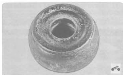
17. ...и нижней подушки 4 стойки штанги стабилизатора. При растрескивании массива резины, сильным обжатии подушек замените их новыми.
