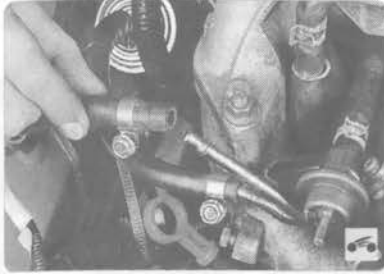
38. Отсоедините шланги подачи и слива топлива и отведите их в сторону.
