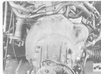
75. Выверните два верхних болта крепления коробки передач (для наглядности показано на снятом силовом агрегате).
