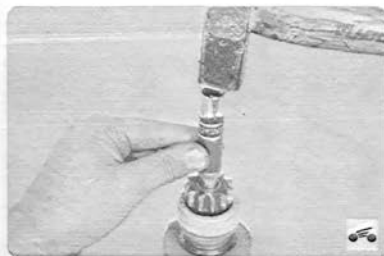
19. С помощью оправки подходящего диаметра сдвиньте по валу привода ограничительное кольцо, как показано на фото.
