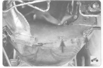
76. Выверните болты крепления нижнего грязезащитного щитка гидротрансформатора.
