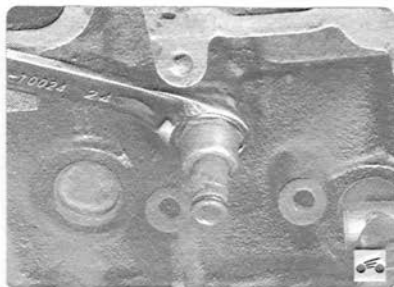
10. Выверните датчик из отверстия в блоке цилиндров.
