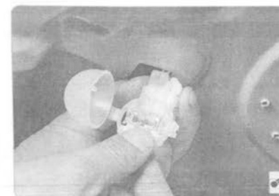
6. Нажмите на фиксатор колодки проводов...
