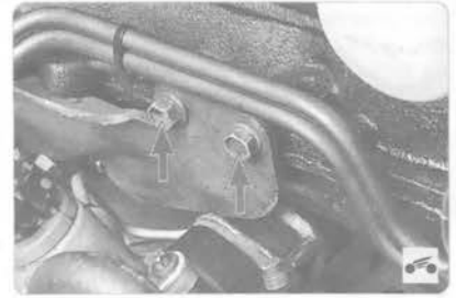
78. Выверните верхние болты крепления защитного экрана гидротрансформатора...
