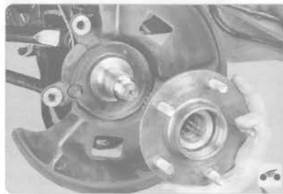
13. Снимите ступицу переднего колеса.
