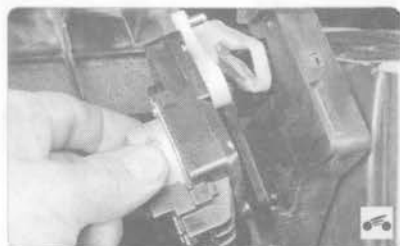
...и нижнего креплений кронштейнов модуля моторному щиту.
