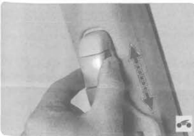
20. Проверьте перемещение и отсутствие заеданий фиксатора механизма регулировки верхней точки ремня.
