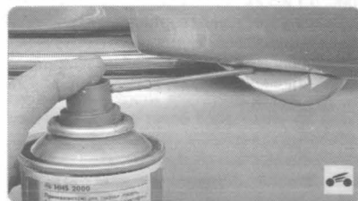
11. Шарниры наружных зеркал (силиконовая смазка или ВТВ-1 в аэрозольной упаковке).
