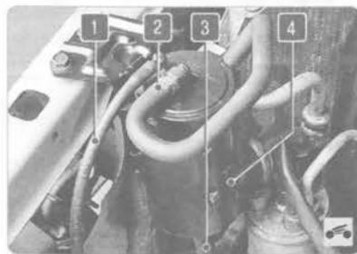
Рис. 5.19. Расположение деталей системы улавливания паров топлива: 1 – вентиляционный шланг продувки фильтра адсорбера; 2 – паропровод отвода паров топлива из топливного бака; 3 – паропровод подвода паров топлива к впускному коллектору; 4 – адсорбер
