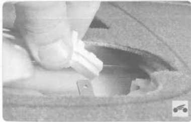
6. Разъедините колодку с проводом под задней полкой...
