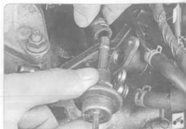
37. Выверните винты крепления регулятора давления топлива.
