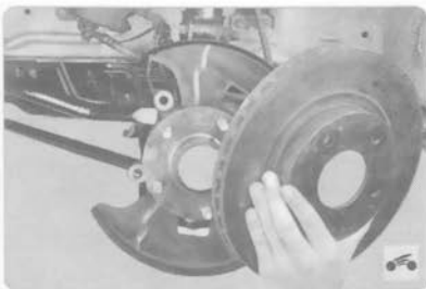
7. Снимите тормозной диск со ступицы переднего колеса.
