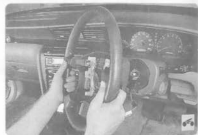
15. Установите кожухи рулевой колонки в порядке, обратном снятию.
