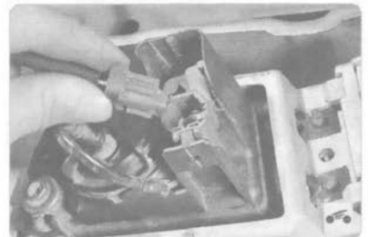
3. ...и отсоедините колодку от лампы противотуманной фары.
