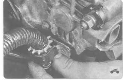
47. ...и отведите жгут проводов в сторону.
