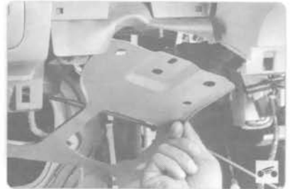
18. Снимите защитный кожух рулевой колонки.
