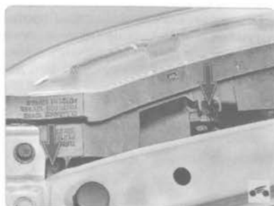
6. Откройте капот и, вращая регулировочные винты...
