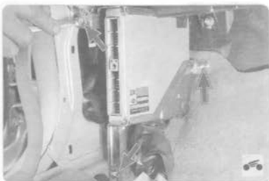
20. Выверните два винта, отверните гайку крепления кронштейна блока управления двигателем к кузову автомобиля...
