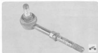
18. Замените стойку штанги стабилизатора при увеличенном люфте пальца или повреждении пыльника.
