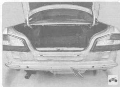
...и задний усилители бамперов, при деформации которых происходит поглощение части энергии удара...
