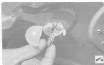
3. Извлеките лампу из контактного разъема плафона освещения багажника.
