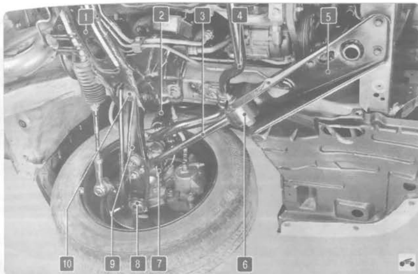
Рис. 4.3. Расположение элементов передней подвески на автомобиле: 1 – поперечина передней подвески; 2 – амортизаторная стойка; 3 – левая реактивная тяга; 4 – штанга стабилизатора поперечной устойчивости; 5 – кронштейн реактивной тяги; 6 – передний шарнир (сайлентблок) реактивной тяги; 7 – поворотный кулак; 8 – шаровая опора; 9 – рычаг передней подвески; 10 – шарнир (сайлентблок) рычага передней подвески
