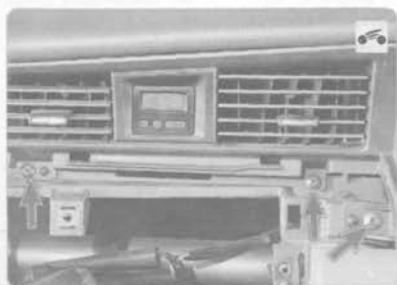
29. Выверните три винта крепления верхней части облицовки к панели приборов...
