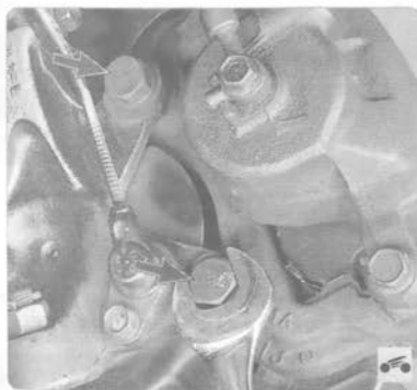
5. Выверните два болта крепления направляющей колодок к поворотному кулаку и снимите суппорт в сборе, не отсоединяя тормозной шланг.
