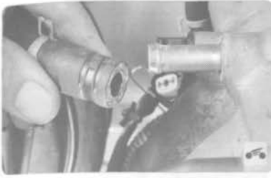
6. ...и отсоедините шланг от патрубка впускного коллектора.
