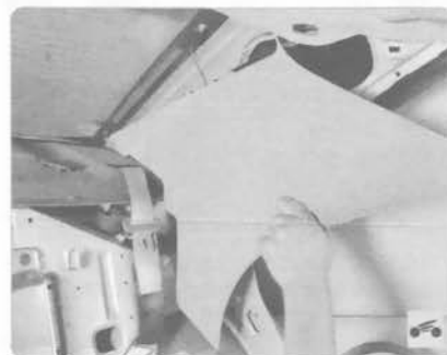
2. Снимите облицовки задней стойки (см. «Снятие и установка облицовок салона», с 306).
