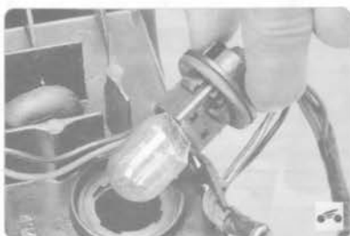
4, 5 – лампы заднего стоп-сигнала/заднего габаритного огня P21W/ 5W.
