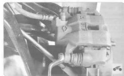
3. Выверните болт крепления нижнего направляющего пальца суппорта...
