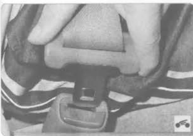
19. После установки обивок проверьте легкость перемещения, отсутствие заеданий и перекручивания ленты ремня.
