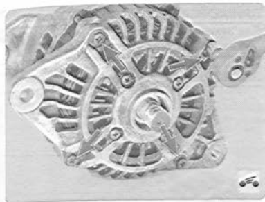
5. Выверните четыре стяжных болта генератора.
