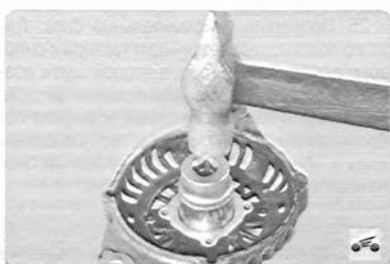
12. С помощью оправки подходящего диаметра запрессуйте новый подшипник в крышку, прикладывая усилие к наружной обойме подшипника.
