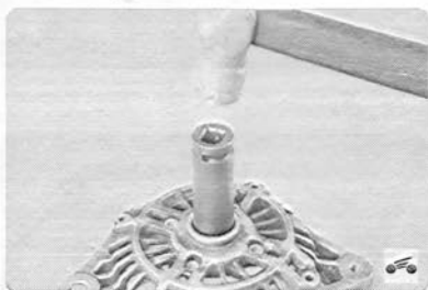
11. Используя оправку подходящего диаметра, выпрессуйте подшипник из верхней крышки.
