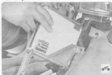
21. ...и снимите блок управления двигателем. 22. Установите блок управления двигателем и все детали в порядке, обратном снятию.
