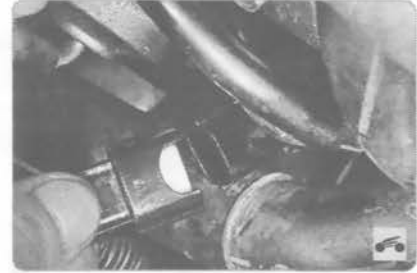
48. Отсоедините колодку жгута проводов от электропневмоклапана, расположенного около термостата.
