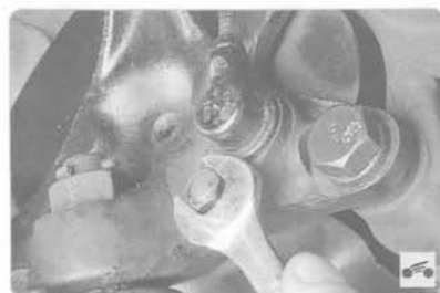
3. Выверните болт крепления датчика скорости 5 (рис. 7.5) из поворотного кулака 2...
