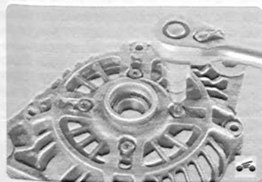
8. С помощью крестообразной головки и воротка строньте винты крепления...
