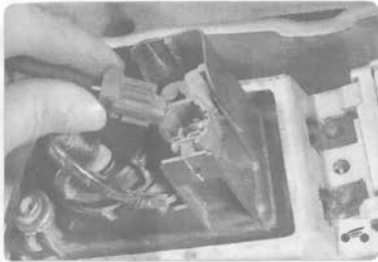
3. ...и отсоедините колодку от лампы противотуманной фары.
