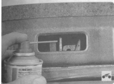
7. ...и петли крышки багажника (моторное масло или силиконовая смазка в аэрозольной упаковке).
