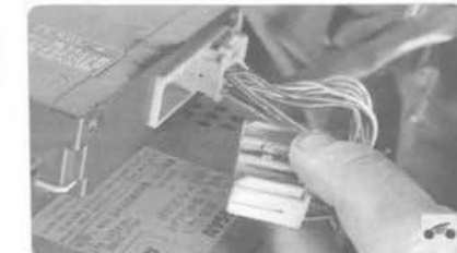
6. Нажав на фиксатор колодки жгута проводов, отсоедините ее от блока управления отопителем, вентиляцией и кондиционером.
