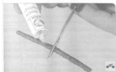
8. Нанесите на жгут слой клея из набора. Поверхность отверстия в шине также обработайте клеем.
