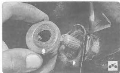
6. Снимите шайбу и извлеките болт.
