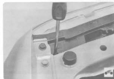
8. ...и вертикали, если расположение световых пятен не соответствует рисунку.
