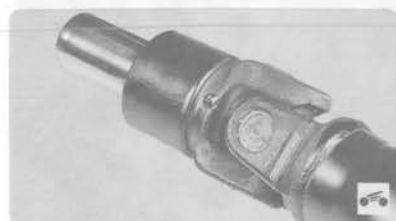
Рис. 6.5. Карданная передача: 1 – передний вал карданной передачи; 2 – карданный шарнир переднего вала; 3 – скользящая вилка; 4 – промежуточный карданный шарнир; 5 – фланец соединения переднего и заднего валов карданной передачи; 6 – промежуточная опора карданного вала; 7 – задний вал карданной передачи; 8 – карданный шарнир заднего вала
