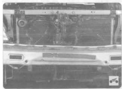
Конденсор (радиатор кондиционера) 5 многопоточного типа (для наглядности показано со снятым передним бампером). Установлен перед радиатором системы охлаждения двигателя. Соты конденсора изготовлены из плоских тонкостенных алюминиевых трубок с внутренними продольными перегородками
