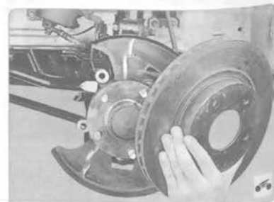
7. Снимите тормозной диск (см. «Замена тормозного диска тормозного механизма переднего колеса», с. 208).
