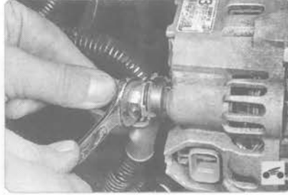
42. Отверните гайку крепления силового провода к генератору..
