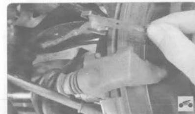
6. Снимите с направляющей колодок две фиксирующие пружины.
