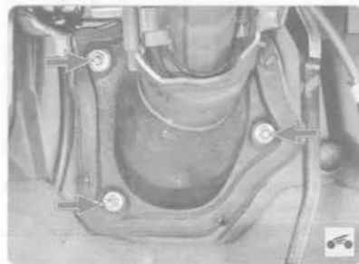
14. Отверните три гайки крепления грязезащитного чехла рулевой колонки к щитку передка.
