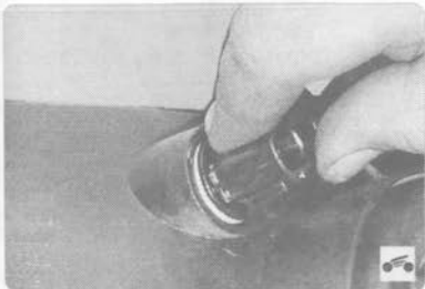
13. Поверните против часовой стрелки патрон с лампой...
