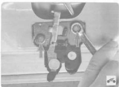
4. Выверните два болта крепления замка багажника...
