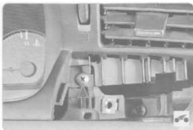
30. ...затем винт правого крепления...
