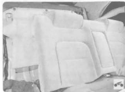
1. Снимите заднее сиденье (см. «Снятие и установка заднего сиденья», с 294).
