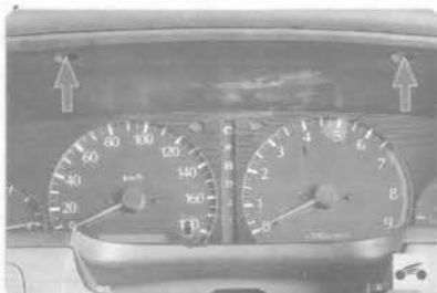
31. ...два винта верхнего крепления облицовки панели приборов...
