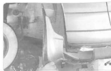
2. Снимите брызговики передних колес (см. «Снятие и установка брызговиков колес», с. 270).
