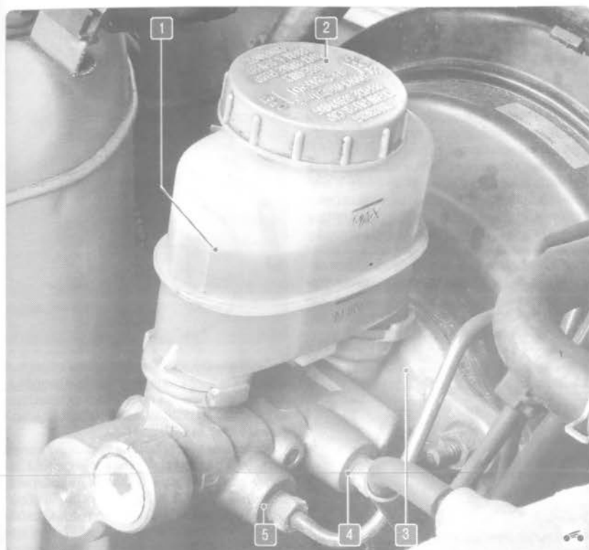
Рис. 9.2. Главный тормозной цилиндр с бачком: 1 – бачок главного тормозного цилиндра; 2 – пробка бачка; 3 – главный тормозной цилиндр; 4 – отверстие под штуцер первого контура; 5 – отверстие под штуцер второго контура
