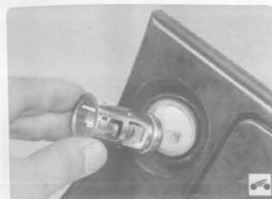
6. ...и извлеките патрон из пластмассовой втулки декоративной накладки (для наглядности показано на снятой декоративной накладке).
