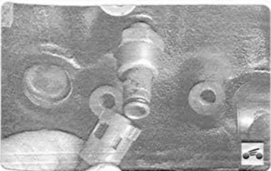
9. ...и отсоедините колодку разъема от датчика детонации.
