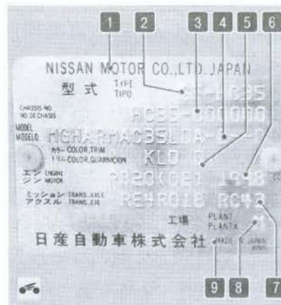
Рис. 1.5. Идентификационная табличка: 1 – фирма-изготовитель; 2 – заводской индекс модели; 3 – номер кузова; 4 – идентификационный номер автомобиля; 5 – коды цвета кузова и цвета салона; 6 – модель и дата выпуска двигателя; 7 – модификация коробки передач и редуктора заднего моста; 8 – завод-изготовитель; 9 – страна-производитель
