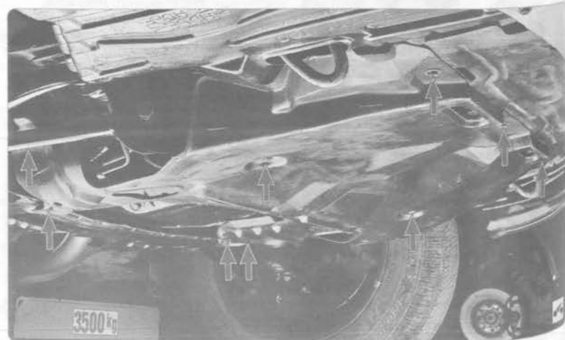
Рис. 5.3. Расположение болтов крепления заднего брызговика к кузову автомобиля
