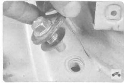
5. ...и отведите пряжку ремня от отверстия в кузове.
