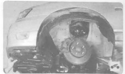
1. Снимите подкрылок переднего колеса (см. «Снятие и установка подкрылков передних колес», с. 270).
