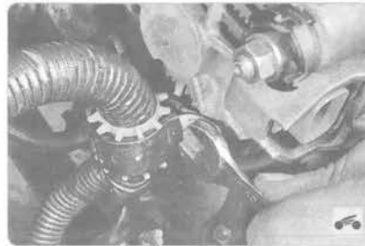
46. Выверните болт крепления держателя жгута проводов к корпусу генератора...
