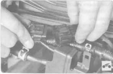
69. ...и разъедините колодку моторного жгута проводов.
