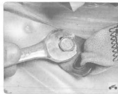
4. Выверните болт нижнего крепления заднего ремня безопасности...
