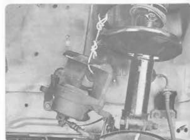
6. ...и подвесьте суппорт на проволоке, например, к пружине амортизаторной стойки, не допуская скручивания или натяжения шланга (см. «Замена суппорта тормозного механизма переднего колеса», с. 208).
