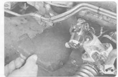
80. Снимите нижний грязезащитный щиток гидротрансформатора.
